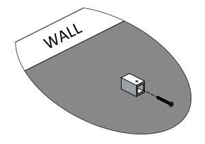
ONCE ASSEMBLED MARK AND DRILL THE TOP BAR WALL SOCKET (ITEM 5). ENSURE THE TOP BAR WALL SOCKET IS LEVEL AND THAT THE GRUB SCREW IS FACING UPWARDS BEFORE FIXING IT TO THE WALL USING ITEMS 10 & 12.
