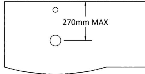
6. DRILL MARBLE  $\phi 35$  FOR TAP AND  $\phi 75$  (MINIMUM) FOR BASIN WASTE ON A SUPPORTED SURFACE. USE DIAMOND CUTTER WITH COOLANT AS REQUIRED
